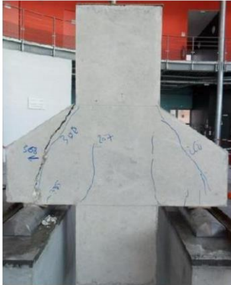
a) C0 : Flexion failure
